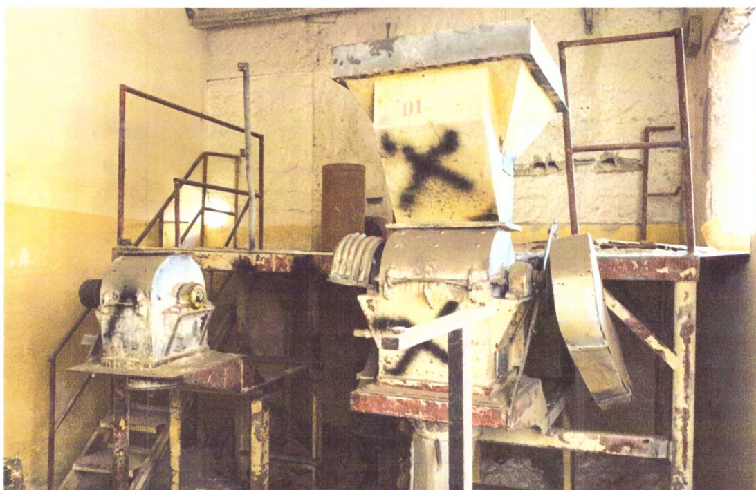
Vista dos 02 Moinhos de Martelo Tigre de Capacidade de 500 Kg/h classificado como máquina e equipamento mutilado
