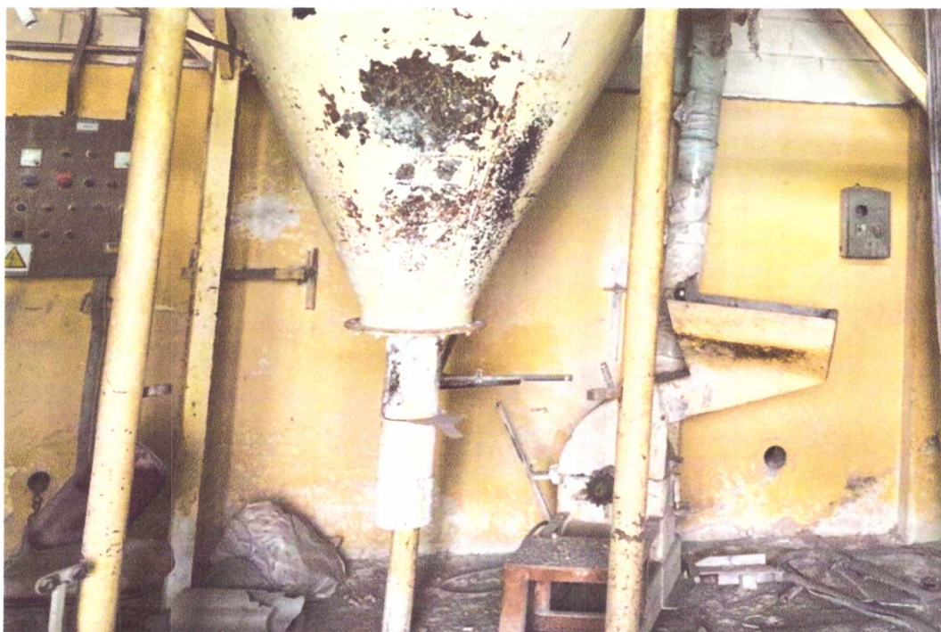
Vista dos Micronizador (moinho) de Cap. 200 Kg/h de 40 CV classificado como máquina e equipamento mutilado
