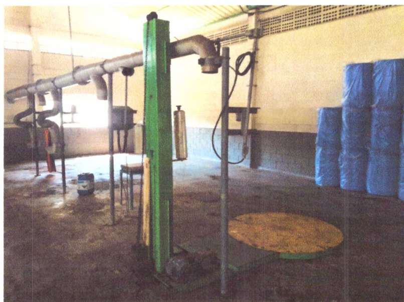
Vista da Máquina de Filme Stretch classificado como máquina e equipamento regular
